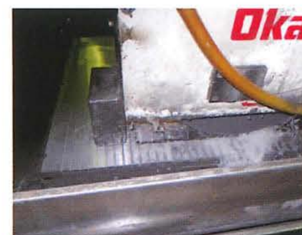
←この囲いの中に砥石がセットされています。平面研磨加工中
